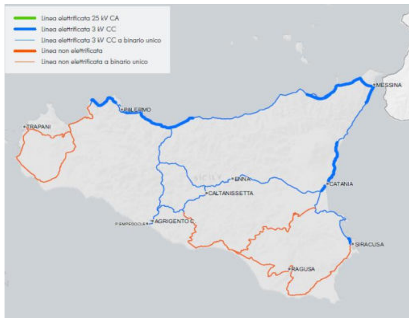
Figura 15 - Sviluppo rete ferroviaria in Regione Sicilia. Fonte: Piano Commerciale RFI - ed. febbraio 2021
